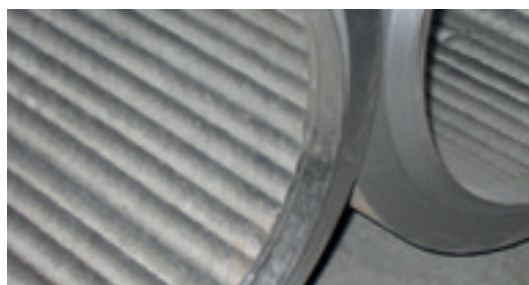
Трубы (никелевый сплав 825) Soudotape 825 + Record EST 236
