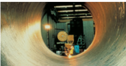
Сепаратор (никелевый сплав 625) Soudotape 625 + Record EST 201
