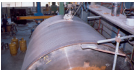
Ролики для протяжки бумаги (сплав 14Cr2Ni1Mo) Soudotape 430 + Record EST 452
