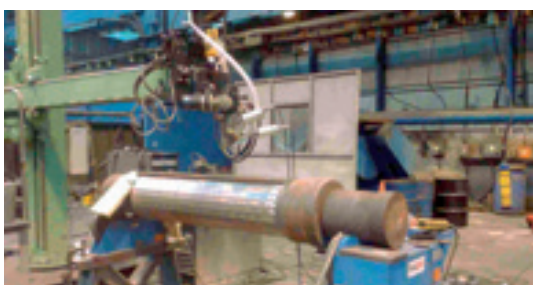
Ковка — штамповочные инструменты (сплав C276) Soudotape NiCrMo59 + Record EST 259 Soudotape NiCrMo4 + Record EST 259
