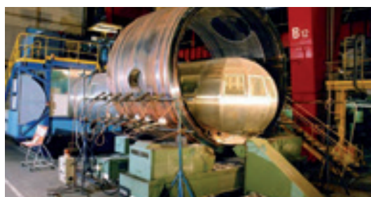
Обечайка резервуара Soudotape 308 L Q5 + Record 8B308T1 Q5
