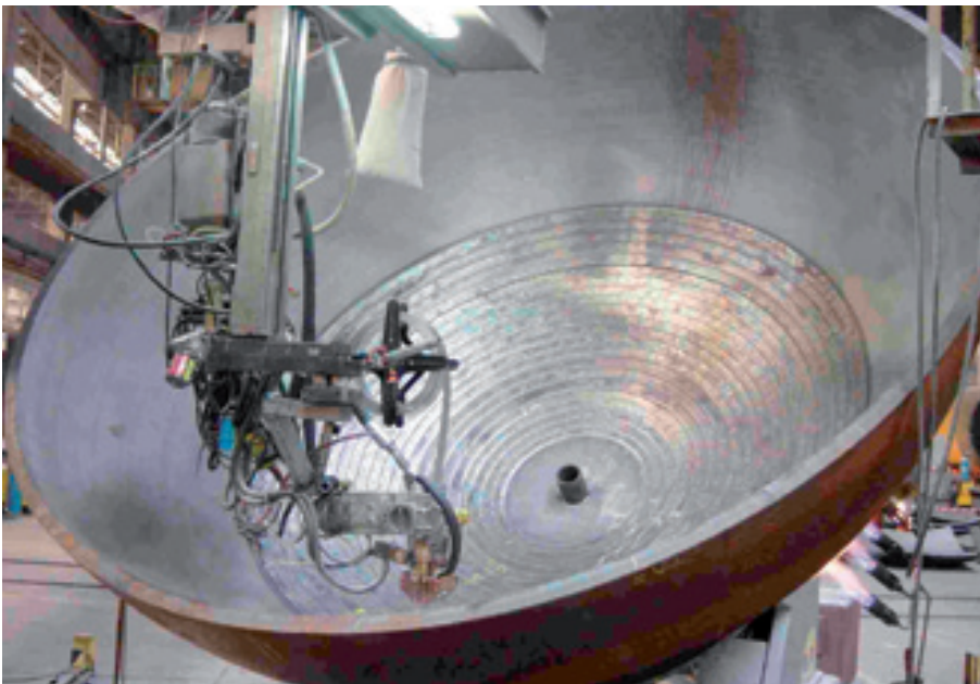
Сепаратор высокого давления (никелевый сплав 825) Soudotape 825 + Record EST 138
