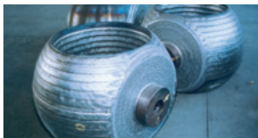
Шаровые клапаны (никелевый сплав 625) Soudotape 625 + Record NFT/EST 201
