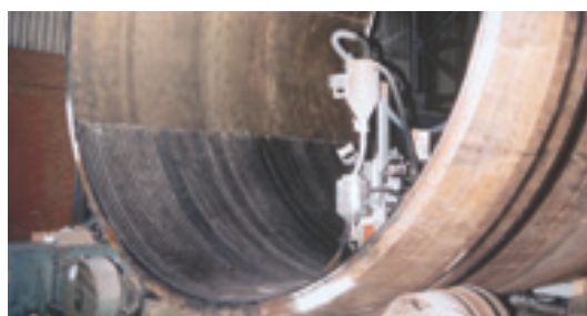
Сепаратор (никелевый сплав 400) Soudotape NiCu7 + Record EST 400
