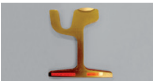
Рельсы (сплав 317L) Soudotape 309L + Record EST 307
