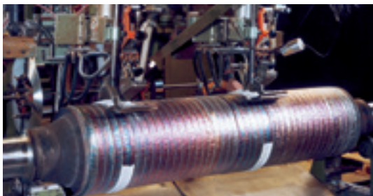
Сталелитейный завод — ролики непрерывного литья (сплав 13Cr6Ni2Mo) Soudotape 430 L + Record RT 168
